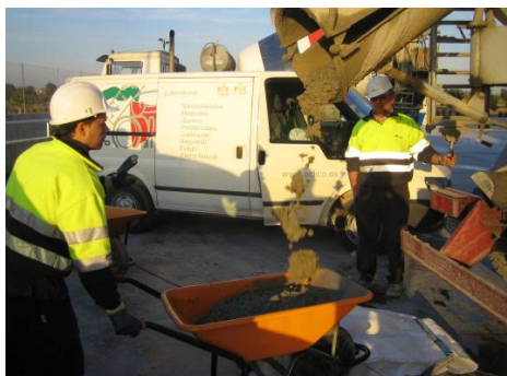
Figura 9: Toma de muestras del hormigón reciclado
