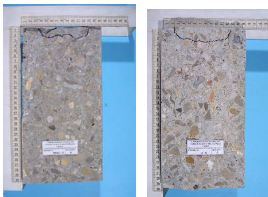
Figura 12: Profundidad de penetración de agua del hormigón reciclado HRV2-5 Y CEMEX 3-6
