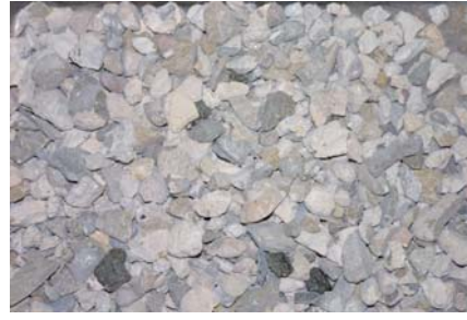
Figura 8: Árido reciclado obtenido de los escombros
