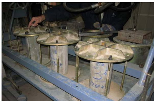
Figura 11: Equipo para el ensayo de penetración de agua bajo presión
