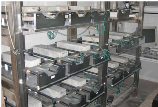
Figura 13: Equipo para el ensayo de retracción
