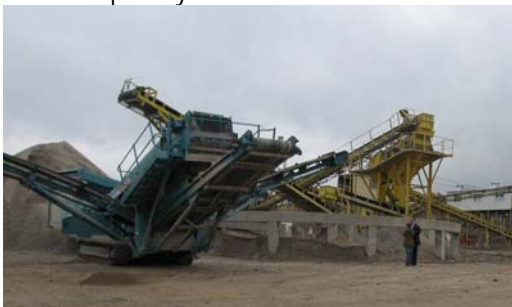
Figura 3. Planta de producción de árido reciclado
